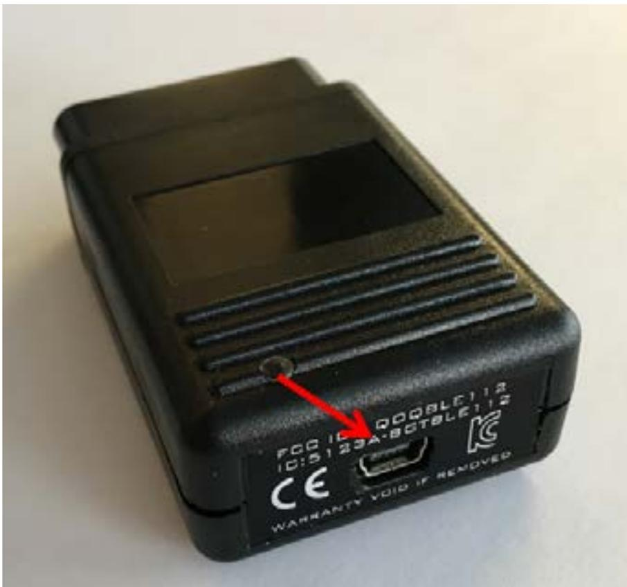
**Figure 1.** Prise micro USB permettant de relier le GAP Flasher à un ordinateur.
