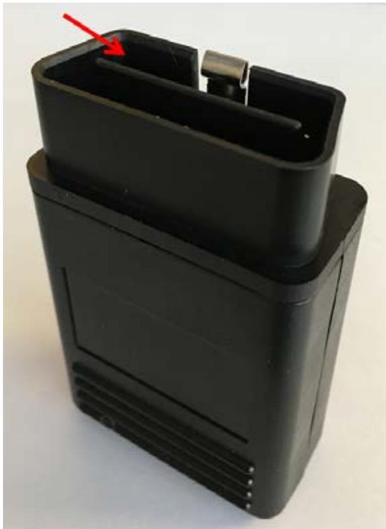
**Figure 2.** Connecteur OBDII pour brancher le GAP Flasher au faisceau de câbles.
