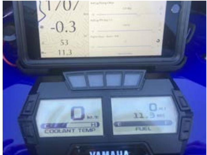
Figure 45. Capteur optionnel AEM O2 a large bande, 11.3 AFR dans cet exemple
