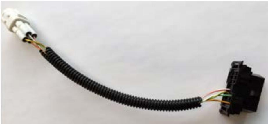
**Figure 4.** Faisceau de câbles pour branchement au port de diagnostic du véhicule.
