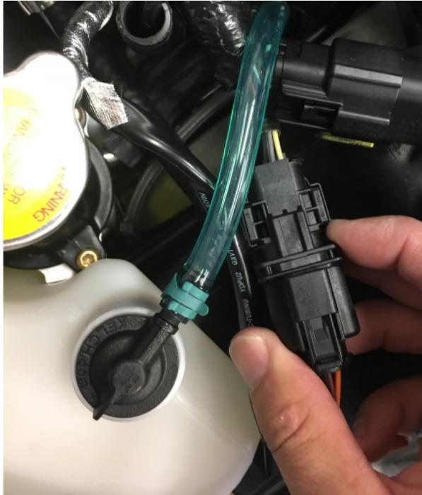
**Figure 6.** Branchement capteur O<sub>2</sub> au faisceau de câbles du module AEM
