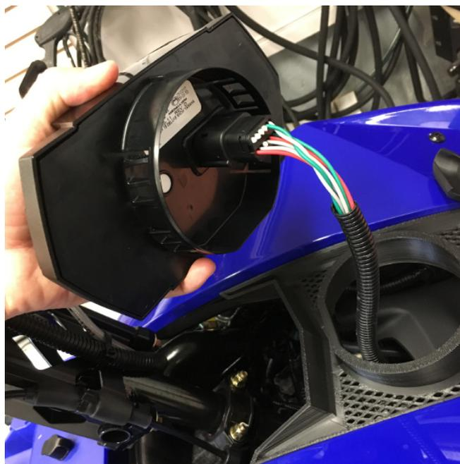
**Figure 36.** Branchement du combiné d'instruments au faisceau de câbles Anti-Retard
