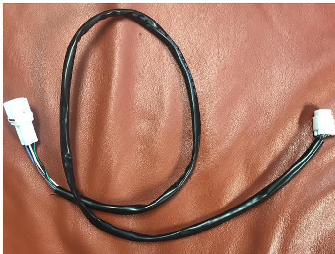
Figure 13. Câblage d'extension # 1 et 2, GF1011
