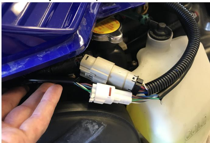
**Figure 19.** Branchement câblage d'extension # 1 et 2, GF1011
