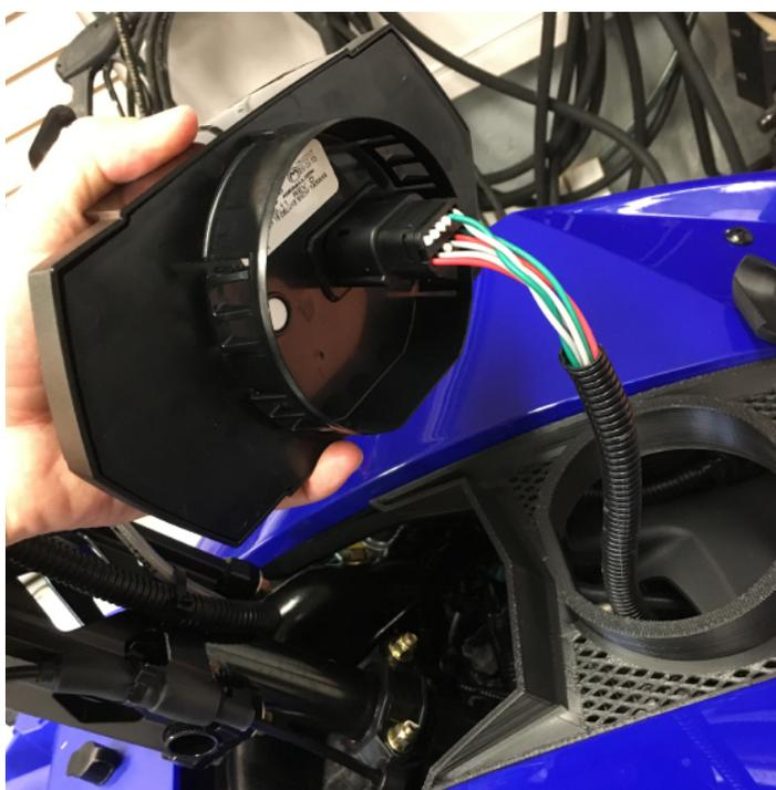
**Figure 12.** Branchement du combiné d'instruments au faisceau de câbles Anti-Retard
