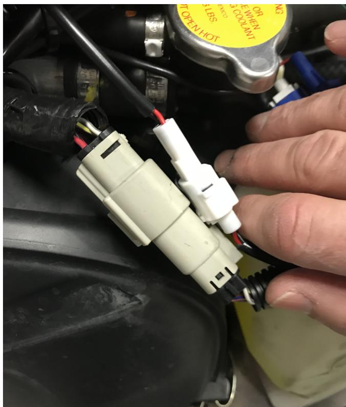
Figure 80. Branchement au connecteur du capot, ACC1009-T ou -B
