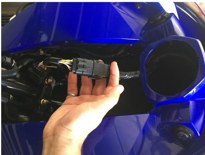
**Figure 11.** Brancher le faisceau de câbles Anti-Retard au faisceau de câbles véhicule
