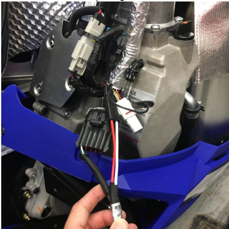
**Figure 4.** Branchement faisceau de câbles AEM O<sub>2</sub>
