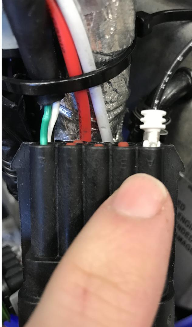
**Figure 51.** Bouton optionnel, câble # 2, port de diagnostic noir, branchement, ACC1009
