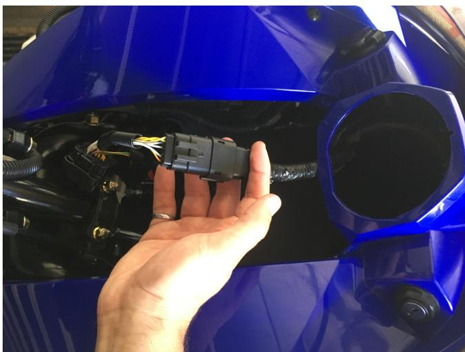
**Figure 25.** Branchement des faisceaux de câbles Anti-Retard et du combiné d'instruments
