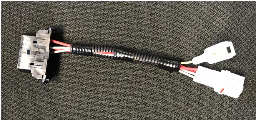
**Figure 49.** Bouton optionnel, câble # 1 GAP Flasher, ACC1009
