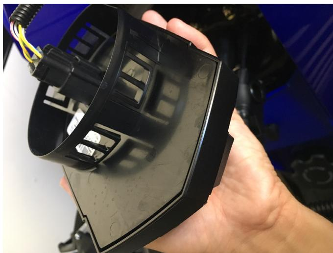
**Figure 10.** Languettes du combiné d'instruments
