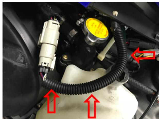
**Figure 18.** Chemin du faisceau de câblage d'extension # 2, GF1011
