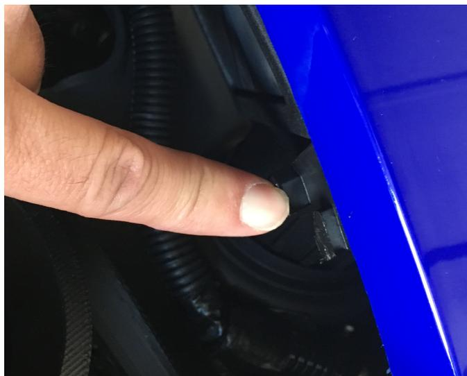
**Figure 27.** Languettes du panneau d'instruments
