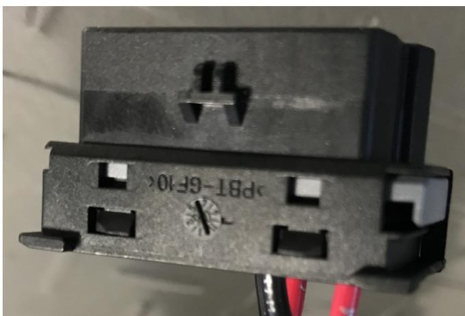
**Figure 69.** Connecteur OBD Anti Retard de type B débarré, ACC1007-L
