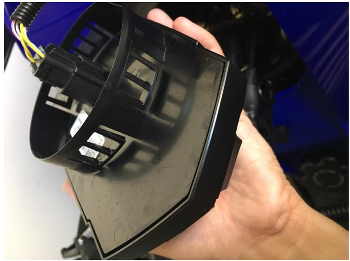
**Figure 23.** Languettes du combiné d'instruments
