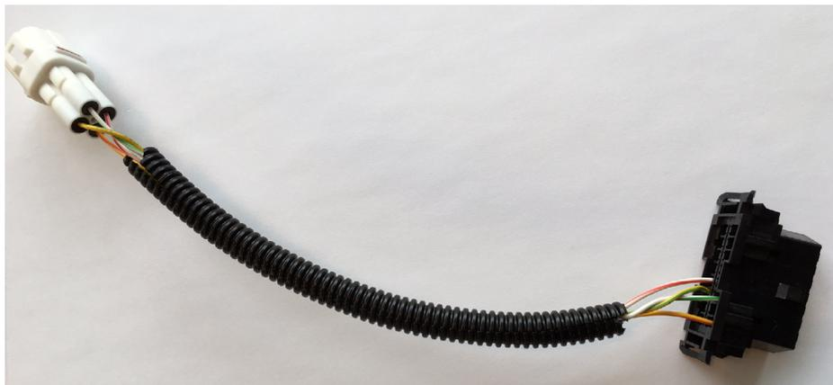
**Figure 2.** Faisceau de câbles pour branchement au port de diagnostic du véhicule.
