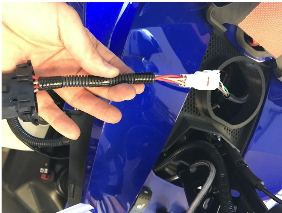
**Figure 20.** Branchement câblage d'extension # 2 et GAP Flasher, GF1011
