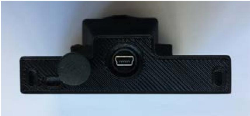
**Figure 1.** Prise micro USB permettant de relier le CoPiTrail à un ordinateur.
