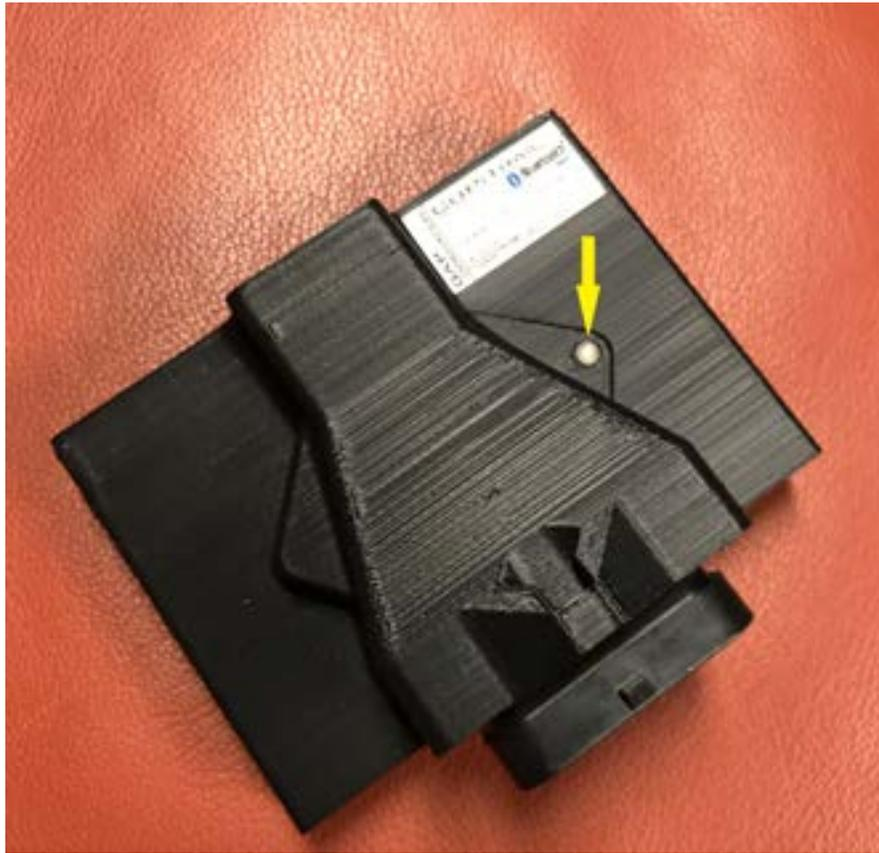
**Figure 4.** DEL indiquant l'état du module. Utilisé a des fins de diagnostic
