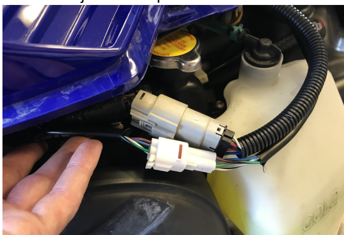
Figure 7. Branchement câblage d'extension # 1 et 2
