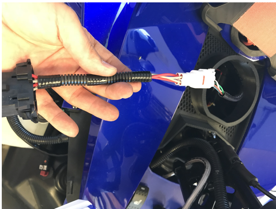
Figure 8. Branchement câblage d'extension # 2 et GAP Flasher
