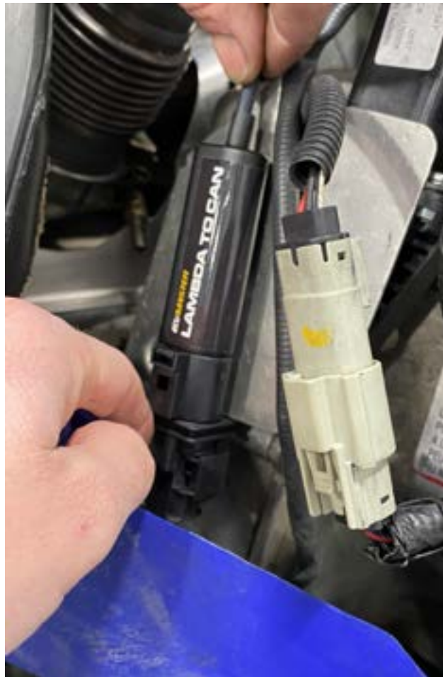
Figure 6. Fixation du module ECU Master
