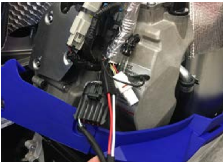
Figure 2. Branchement faisceau de câbles AEM O 2
