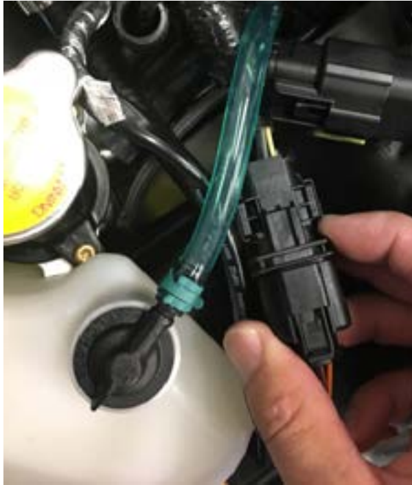
Figure 4. Branchement capteur O 2 au faisceau de câbles du module AEM
